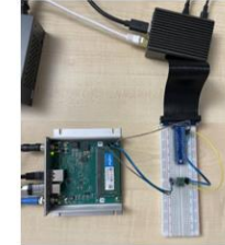
Abbildung 1: Anschluss des seriellen Ports an der Komponente (links unten) an einen Raspberry Pi (rechts oben)
